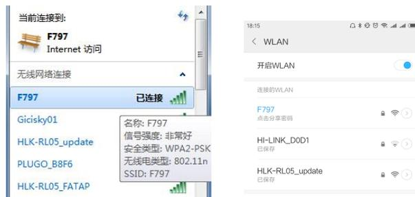
4) 在电脑和手机上都和模块建立 TCP 连接，连接成功后，即可通过此网络连接和模块的串口间透传数据，具体效果如下图。
