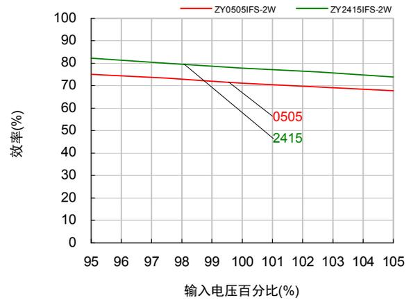
效率与输入电压关系曲线图 (满载)
